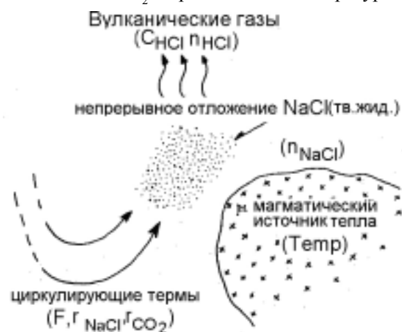
Рис. 2. Схема простой модели системы потоков используемой для миграции \text{HCl} в паровой фазе (Kazahaja, Shinohara, 1991).
