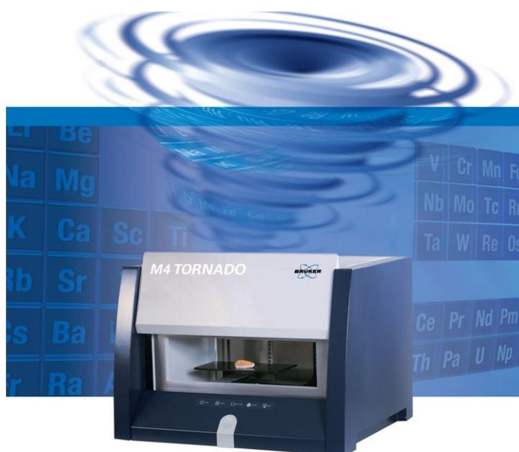
Основная специфика анализа минералогических объектов - необходимость получения информации о элементном составе образца с очень малой области поверхности с пределами обнаружения зачастую лучше или равными 0,1 мас.%. Для решения этой задачи компания Bruker Nano разработала новую линейку специальных рентгенофлуоресцентных (РФА) M4 Tornado.
