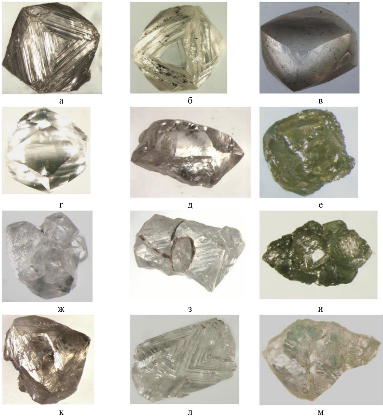
Рис. 1. Разновидности и габитусные формы кристаллов алмаза трубки Луэле. Разновидность I (монокристаллы): тонколаминарный октаэдр в комбинации 111-110-100 (а,×3,2); переходная форма ОД (б,×5); додекаэдроид с реликтами дитригональных граней 111 (в,×5); додекаэдроид «уральского типа» (г,×4); додекаэдроид удлинённый по L_3 (д,×5); разновидность II, жёлтый кубоид в комбинации с 110 (е,×8); разновидность VII: незакономерный сросток додекаэдроидов (ж,×8); незакономерный сросток кристаллов ОД с коррозионными каналами (з,×1,6); разновидность IX: мелкокристаллический «борт» (и,×6,3); разновидность I (двойники и сростки): параллельный сросток кристаллов ОД с протосколами (к,×6,3); шпинелевый двойник 110-111 груболаминарный (л,×5); неклассический двойник додекаэдроидов с протосколами и трещинами (м,×2,5).
